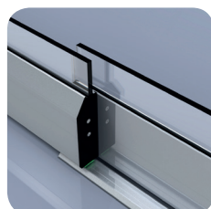
Detalle sección horizontal inferior
