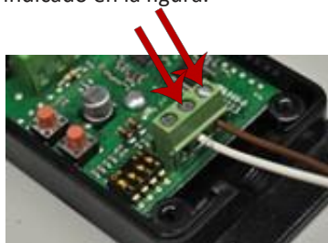
Conexión hilos cable resistivo
